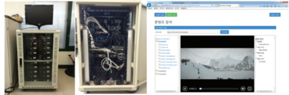
(그림 7) 초다시점 영상 압축/관리를 위한 하둡 기반 분산 처리 시스템(ETRI 개발)
