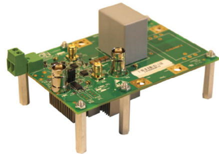
(그림 12) GaN E-HEMT half-bridge 평가보드 (GS66508T-인덕터 불포함)[10]
