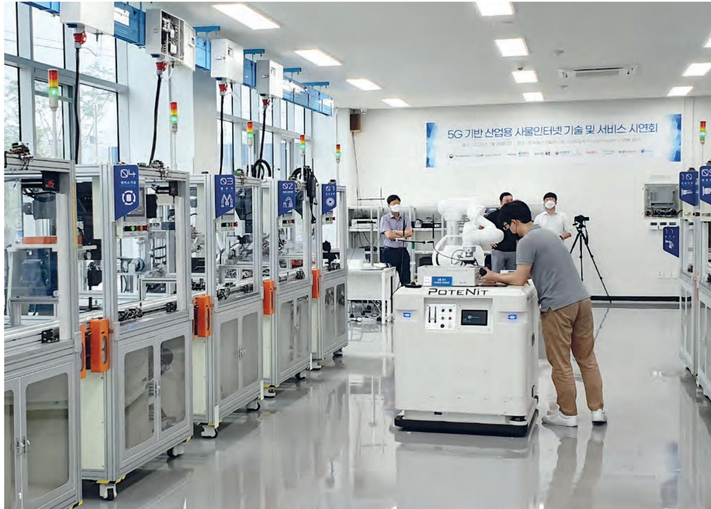
고도의 자동화 시스템이 갖춰진 스마트팩토리에서는 사람들을 대신해 이동형 로봇이 일을 한다. 스마트팩토리에서는 고객의 요구사항에 따라 다변화된 제품을 생산하기 위해 작업자가 패널, 컨트롤러를 이용해 생산 공정을 변경할 수 있고, 변경된 공정에 맞게 제품이 만들어지도록 이동형 로봇이 생산 설비들을 연결하는 유연한 대응 능력이 필요하다. 이것을 가능케 하는 것이 바로 5G 이동통신 기술이다.
