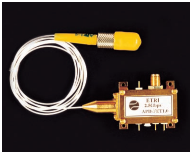
Laser Welding 공정을 이용해 개발한 고신뢰도의 2.5Gbps 광송신 및 광수신 모듈
