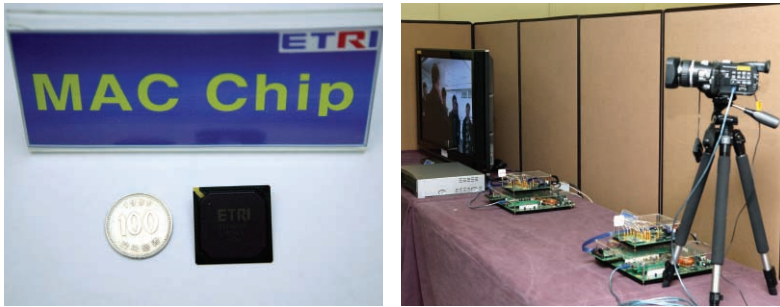
ETRI는 2003년부터 UWB 기술과 무선 1394 SoC 개발을 추진했다. UWB를 이용한 전송 시연 시스템과 UWB용 MAC Chip.
