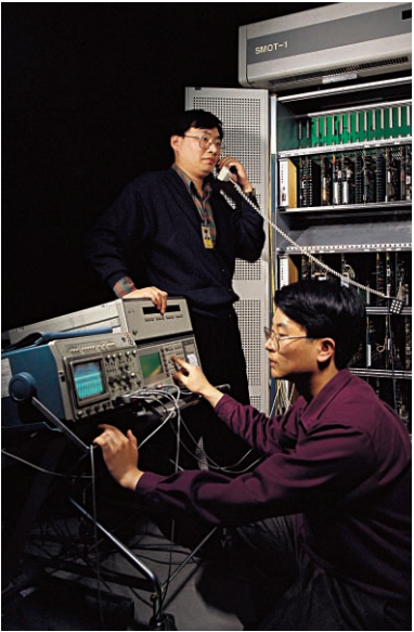
통신망의 동기화와 국제 단일 표준 규격에 따라 1991년 개발한 155Mb급 동기식 다중화 시스템 SMOT-1.
