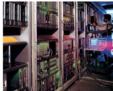
TDX-10은 종합정보통신망(SDN)을 위한 다양하고 새로운 기능 등을 제공하는 대용량 전자교환기이다.
