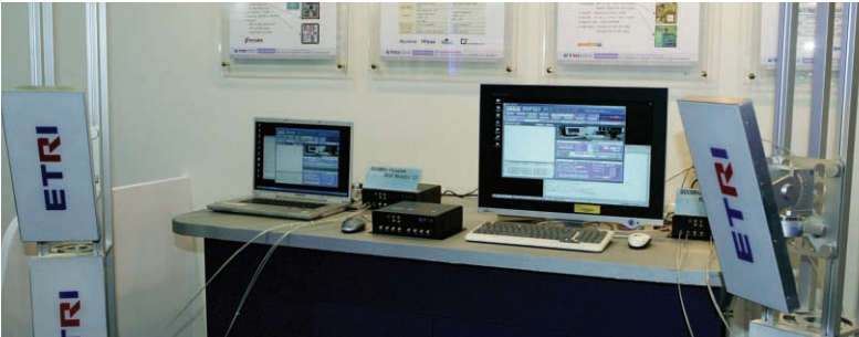
RFID 전시회에서 선보인 900MHz 수동형 RFID 시스템. RFID는 바코드를 대체하여 유비쿼터스를 선도하고 있다.
