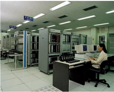
ETRI가 개발한 CDMA 이동통신 기지국 시스템
