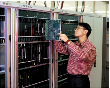
ETRI는 HAN/B-ISDN 프로젝트를 통해 ACE 64에 이어 ACE 256을 개발, 2000년부터 초고속 국가망에 적용했다.
