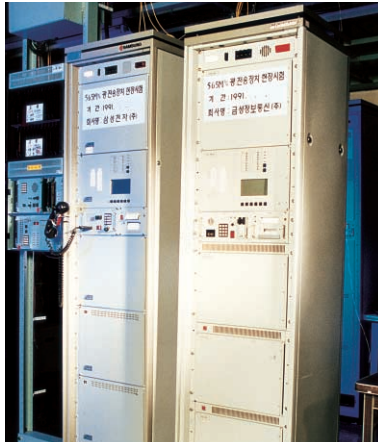
ETRI가 1988년 개발에 성공, 국내 전송기술을 획기적으로 개선시킨 565Mbps 광통신 시스템은 1991년 상용화되어 ISDN 구축에 크게 기여했다.
