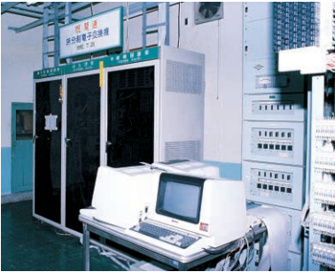
3차 시험기(TDX-1X)는 1982년부터 362회선 가입자를 대상으로 현장시험 운용을 개시했다. TDX-1X는 기본 구조와 타임스위치 방식 등 TDX-1의 토대가 됐다.
