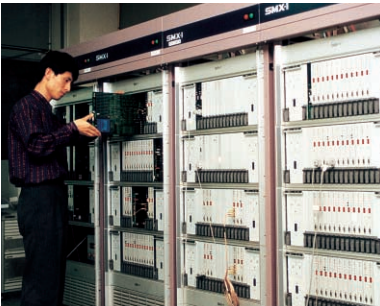
1991년에 개발된 신호중계 교환기 SMX-1 실험 시제품. SMX-1 개발기술은 향후 이동통신망을 비롯한 관련 기술 분야의 연구개발에 활용됐다.
